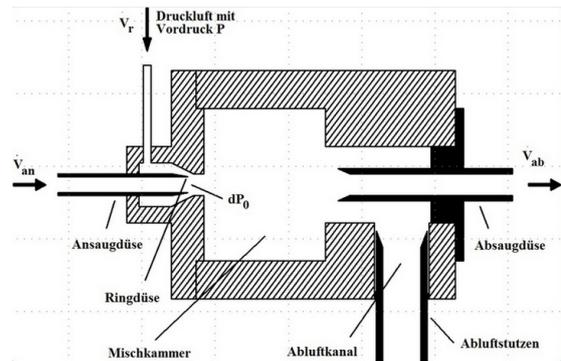
Die Ansaugdüse wird durch einen Ringspalt mit partikelfreier Luft mit dem Volumenstrom V<sub>R</sub> umströmt. Dadurch wird nach Bernoulli ein Volumenstrom V<sub>An</sub> in der Ansaugdüse erzeugt.
